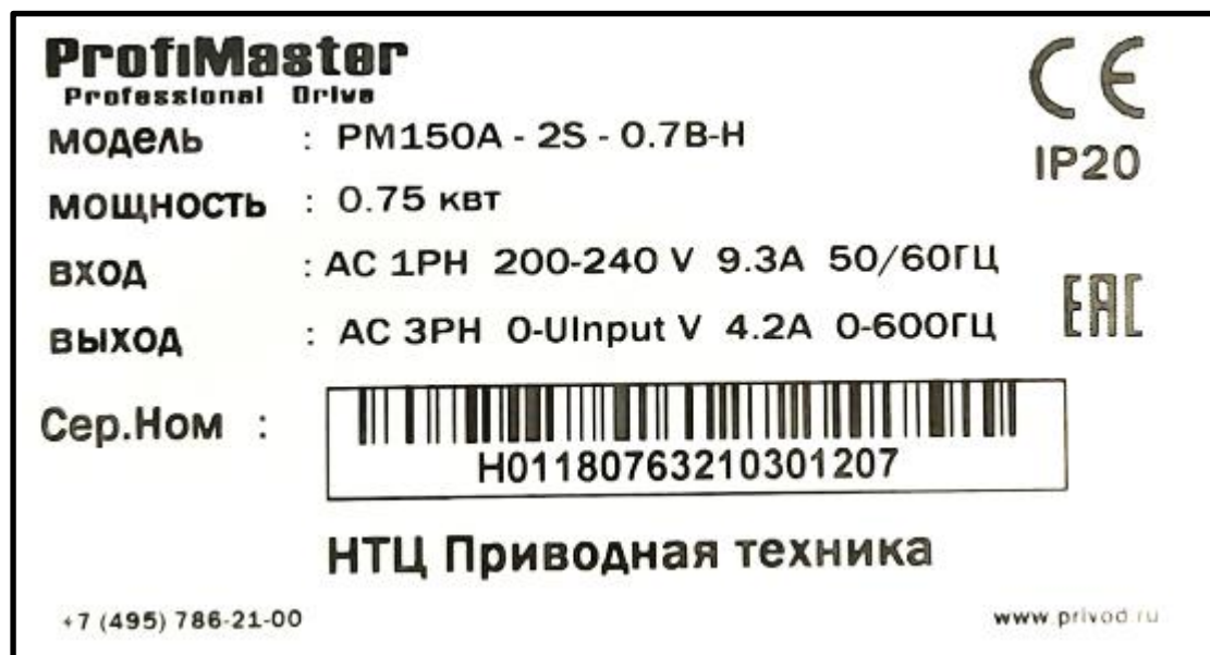
Рис. 2-1 б. Шильд преобразователя частоты (пример для однофазного ПЧ, 0,75 кВт).
